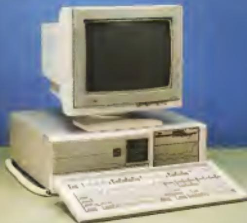
scheda del processore è possibile installare a scelta il coprocessore matematico Intel 80387 od il più potente Wattek 3167. Fra le altre caratteristiche del sistema citiamo solo le possibilità di attivare la funzione di shadow RAM per velocizzare l'esecuzione del BIOS e la presenza di serie di due porte seriali ed una parallela.
